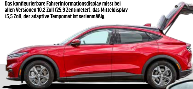
Mach-E-Modelle mit Heckantrieb rollen ab Werk auf 225/60 R 18 mit 7 x 18-LM-Rädern im Fünf-speichen-Design (Bild), die Allradler auf 225/55 R 19-Bereifung (7 x 19-LM-Felgen, fünf Speichen Y)
