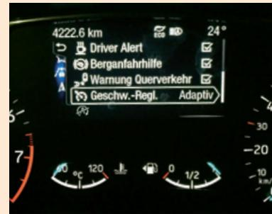
Keine Knöpfe: Die Fahrerassistenz werden im Cockpit aktiviert. Der adaptive Temporegler (unten) arbeitet im Bereich zwischen 30 und 200 km/h, bremst und beschleunigt selbstständig.
