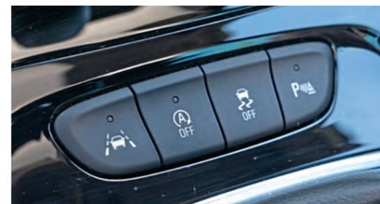
Start-Stopp-System: Der Neustart des Motors erfolgt erst nach Lösen der Bremse
