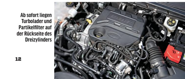
Ab sofort liegen Turbolader und Partikelfilter auf der Rückseite des Dreizylinders
