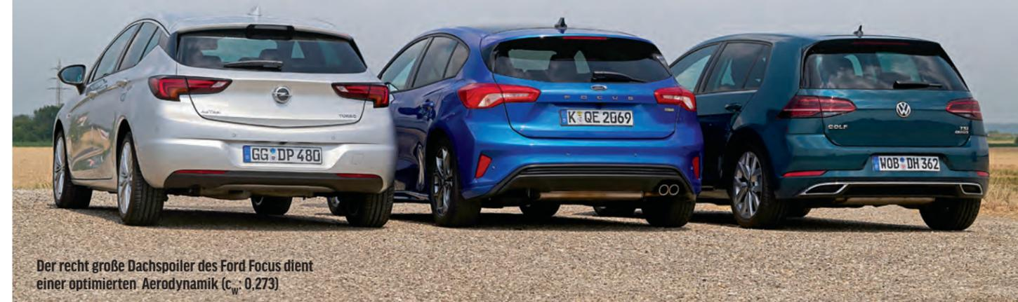
Der recht große Dachspoiler des Ford Focus dient einer optimierten Aerodynamik (c<sub>w</sub>: 0,273)
